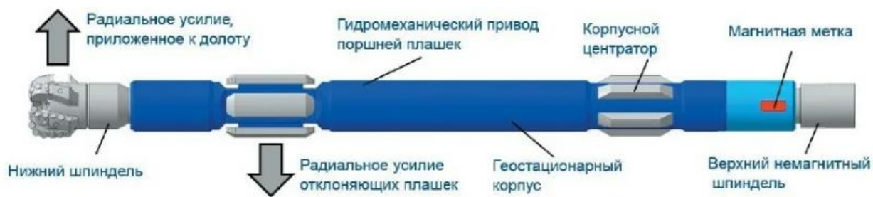
Рисунок 2. Общая схема роторно-управляемой системы
