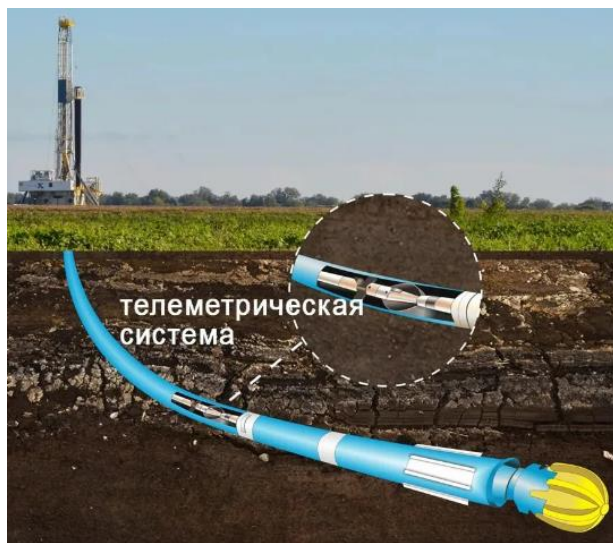
Рисунок 1. Расположение модуля MWD в процессе бурения скважины
