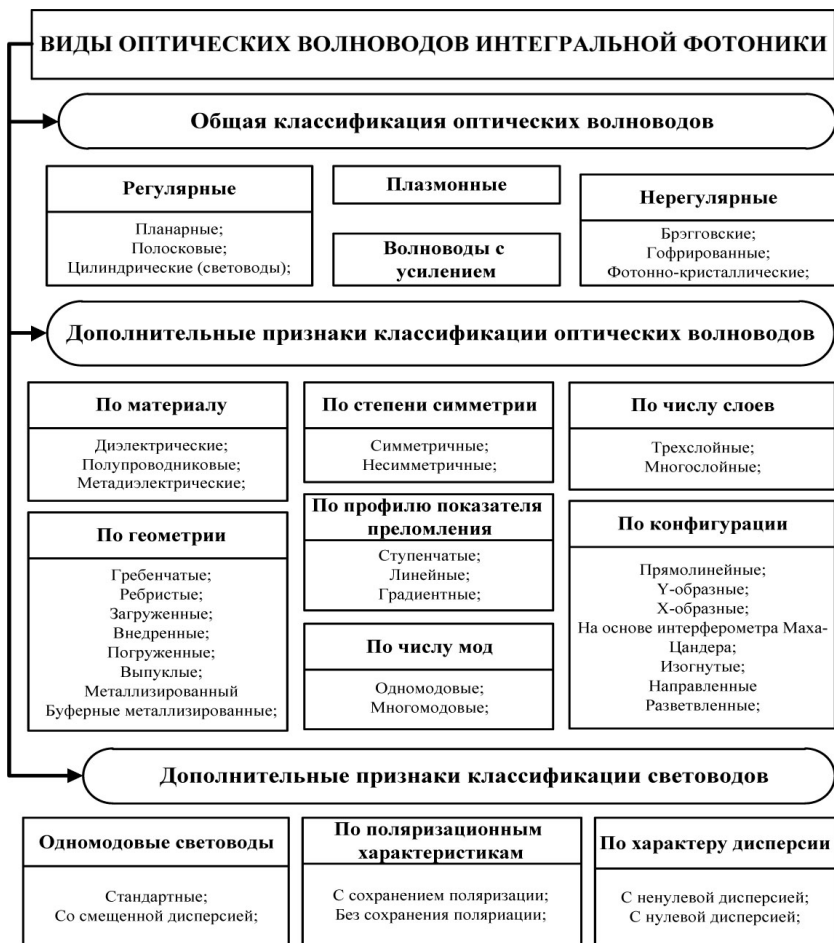
Рисунок 4. Основные виды оптических волноводов
