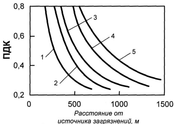
Рисунок 6. Изолинии предельно допустимой концентрации загрязнения (ПДК) вокруг очага выбросов вредных веществ, полученные с помощью нейросетевого метода анализа. Обозначения: 1- H=10 м; 2- H=20 м; 3- H=30 м; 4- H=40 м; 5- H=50 м
