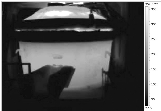
Рисунок 1. а) Термограмма дуговой печи со стороны сливного носка;
