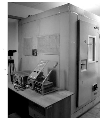
1 — пульт управления, 2 — генератор низких частот, 3 — тепловизор. 4 — окошко для доступа в камеру во время проведения экспериментов; 5 — смотровое окно, 6 — система регулировки температуры.
