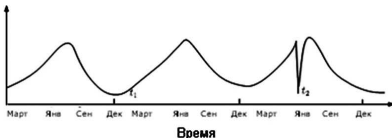
Рисунок 2. Контекстуальная аномалия в температурном временном ряду. Надо заметить, что температура во время t_1 такая же, как и во время t_2 , но находится в ином контексте и поэтому не рассматривается как аномалия.
