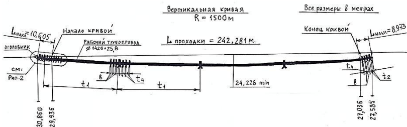
Рисунок 10. Схема протягивания рабочего трубопровода в бетонном тоннеле на переходе через Сайменский канал на км 855 на участке Грязовец — Выборг Северо-Европейского газопровода
