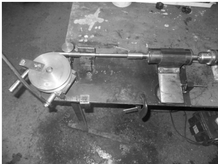
Рисунок 5. Установка для гибки мелкоразмерных труб
