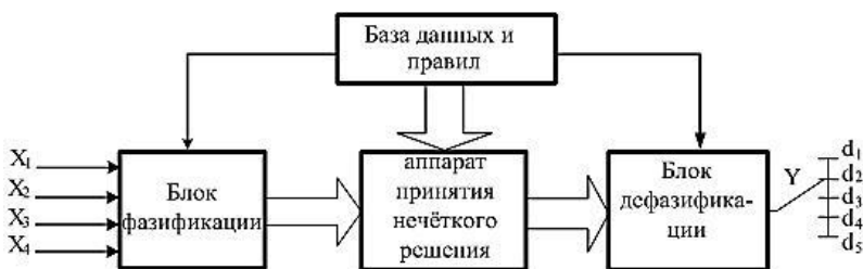
Рисунок 1. Структура блока нечеткого логического вывода системы управления ВЭТУ
