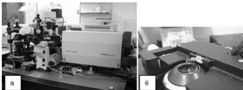
Рисунок 3. а — Прибор Ntegra Spectra; б — Камертон с СБОМ-зондом закреплен в столик SNLG01SNA
