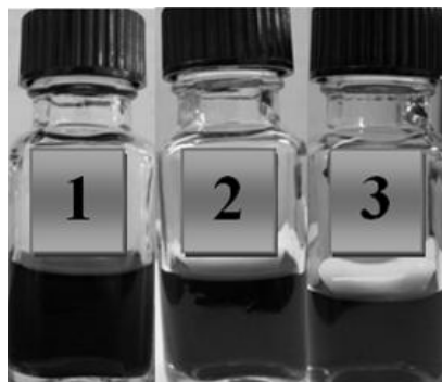
Рисунок 1. Образцы НЧЗ, полученные в присутствии ПВПД с молекулярной массой 10·10 3 (1), 40·10 3 (2) и 350·10 3 (3).
