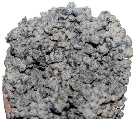
Рисунок 2. Внешний вид спеченных агломератов и их разломы
