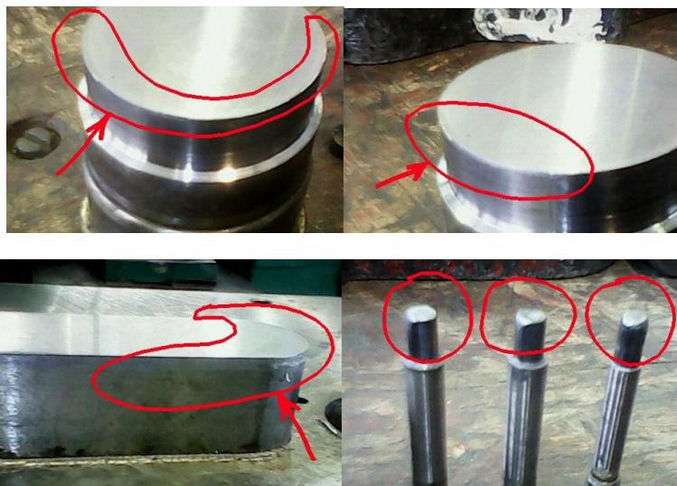
Рисунок 3. Картины износа пуансонов
