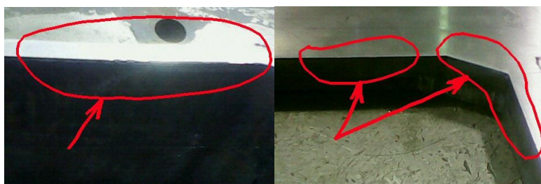
Рисунок 3. Картины износа пуансонов
