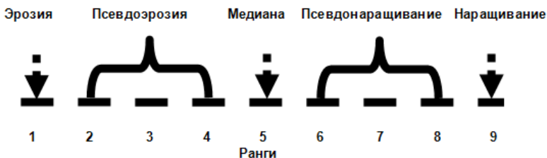
Рисунок 1. Названия процентильных фильтров и соответствующие им ранги в вариационном ряду для маски фильтра размером 3x3
