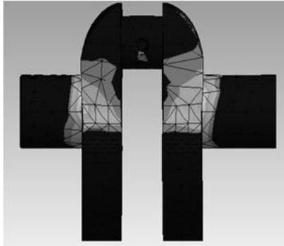
*Рисунок 3. Напряжение по Мизесу, фронтальная зона щеки коленчатого вала*
