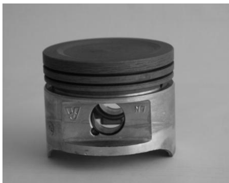
Рисунок 1. Поршень с оксидированным днищем и канавками под поршневые кольца
