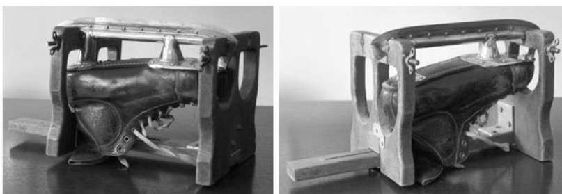
Рисунок 2. Станок для заточки коньков хоккеистов сборной СССР 1950—60-е годы
