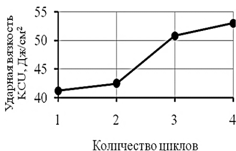
Рисунок 2. Влияние количества циклов на ударную вязкость стали 45
