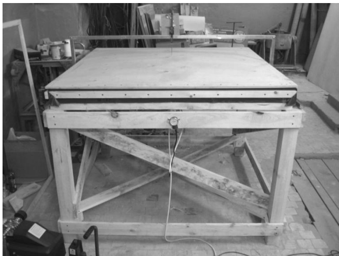
Рисунок 3. Общий вид испытательного стенда для исследования деформационных свойств пневматической опалубочной системы комбинированного типа
