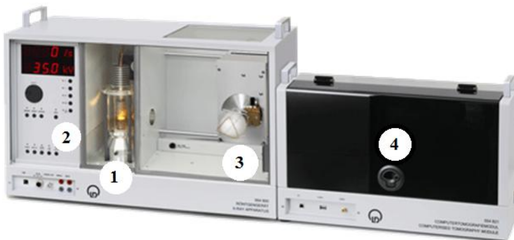
Рисунок 2. Устройство компьютерного томографа
