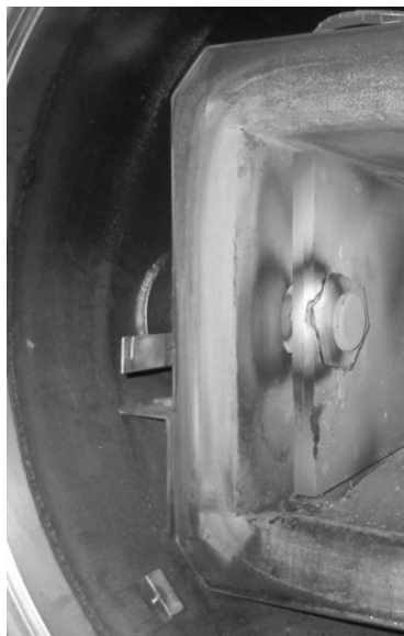
Рисунок 3. Разрушение углеродного нагревателя печи ВОж-16-22 после проведения экспериментов с CO_2
