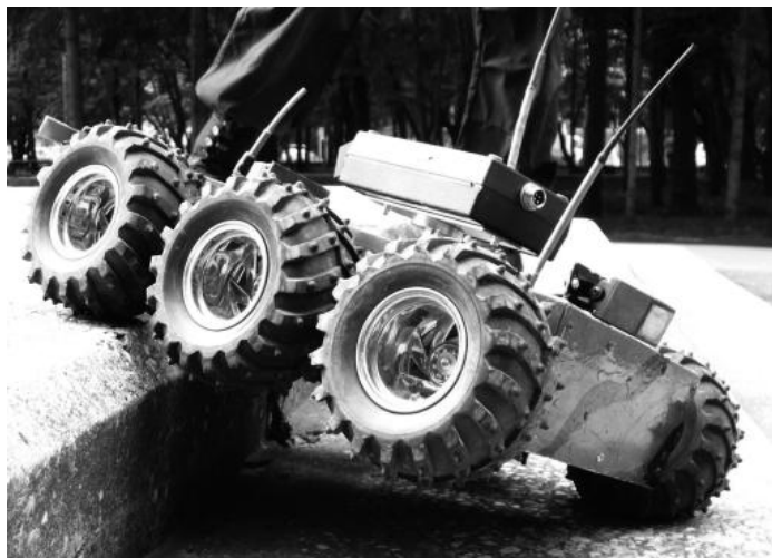
Рисунок 5. Спуск по ступеням диагонально
