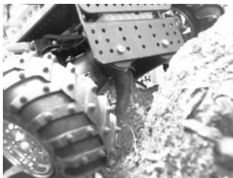
Рисунок 9. Авария, вызванная открытой конструкцией подвески робота «МСЦ»
