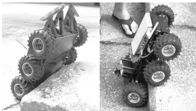
Рисунок 7. Роботы в процессе преодоления ступени
