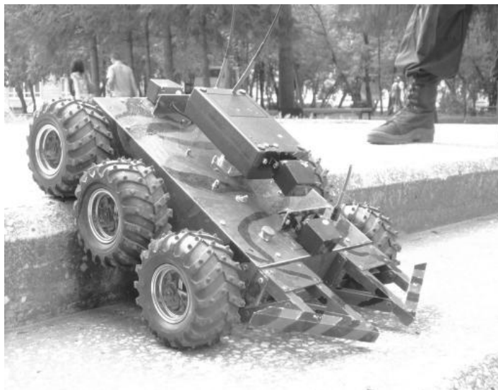
Рисунок 4. Спуск по ступеням с использованием вынесенной опоры
