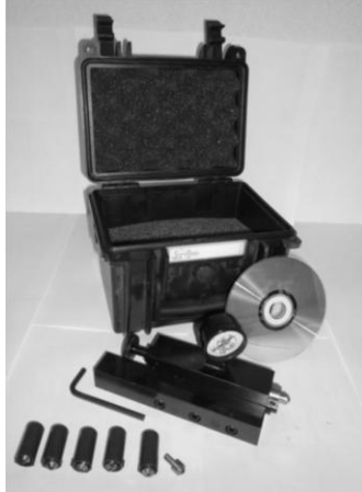
Рисунок 2. Устройство для обработки ППД на универсальных станках
