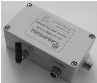
Рисунок 7. Устройство преобразования и передачи информации (УППИ) в качестве оконечного терминала кластера беспроводной сенсорной сети на основе сетевой технологии ZigBee для системы мониторинга загазованности
