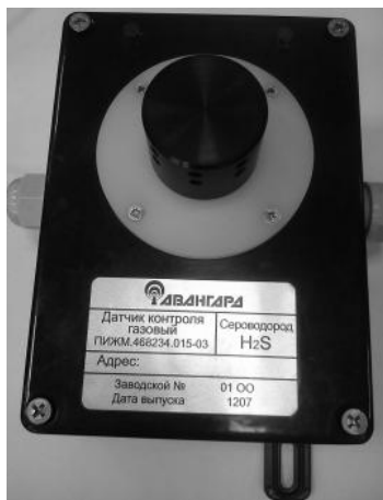
Рисунок 6. Газовый датчик АВУС-ДТ
