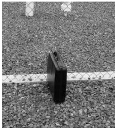
Рисунок 4. Бесконтактный генератор трассоискателя
