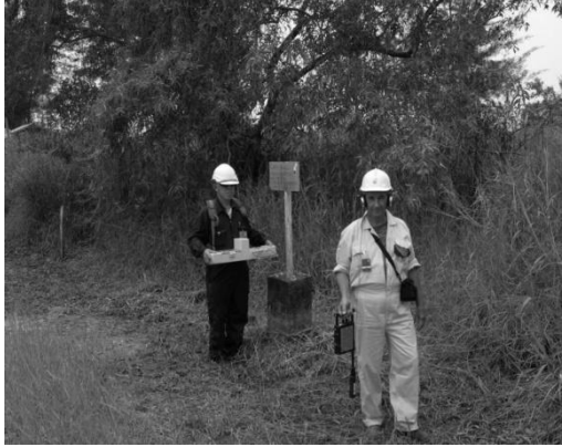
Рисунок 5. Обследование подземного и надземного трубопроводов магнитометром СКИФ
