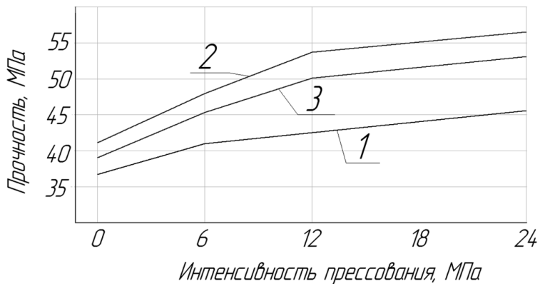
Рисунок 1. Влияние на прочность прессованного бетона (М 500) совместного действия дисперсного армирования и пластифицирующей добавки; 1 — контрольные образцы; 2 — образцы из армированного бетона с расходом фибра 1,5 % от количества цемента и пластификатора 0,5 %; 3 — то же, количество фибра — 3 % и добавки 1 %
