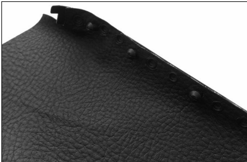
Рисунок 5. Крепление деталей с помощью ультразвуковой сварки
