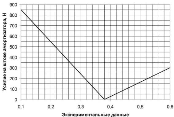
Рисунок 2. Тарировочная характеристика установки для диагностирования амортизаторов
