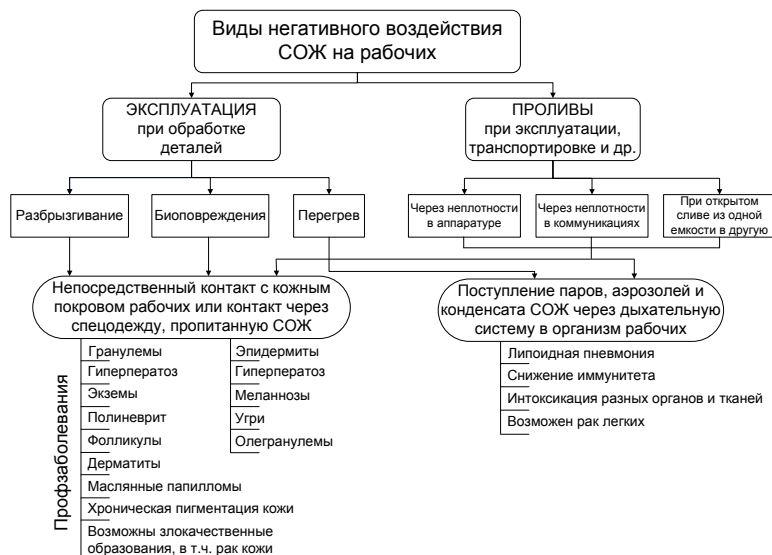
Рисунок 1. Основные пути поступления вредных веществ СОЖ в организм рабочих и вызываемые профессиональные заболевания
