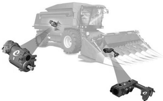
**Рисунок 2. Схема расположения узлов гидравлических двигателей и приводов**
