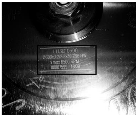
Рисунок 2. Информационное клеймо дисковой пилы
