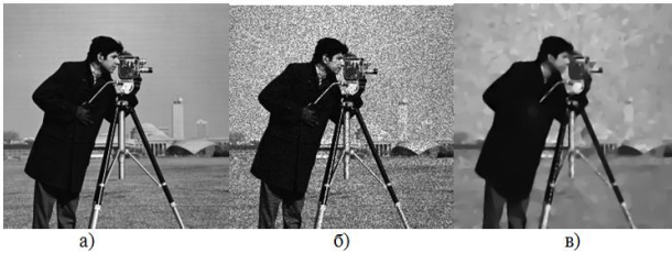
Рисунок 1. Устранение шума на изображении. а) Исходное изображение; б) Зашумлённое изображение PSNR=19; в) Подавление шума PSNR=25, \lambda = 0.001
