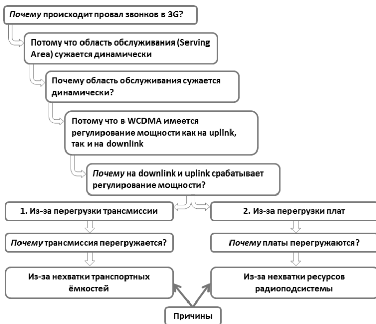
Рисунок 1. Диаграмма (упрощенная) причинно-следственных связей провалов звонков в 3G (WCDMA)
