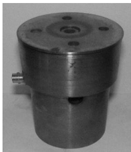
Рисунок 3. Датчик дульной скорости, калибр 8 мм
