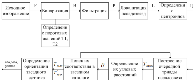
Рисунок 8. Общая схема программно-математического обеспечения звездного датчика
