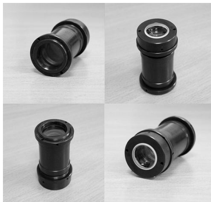
Рисунок 3. Оптическая система экспериментального образца звездного датчика
