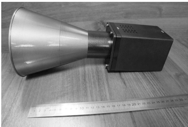
Рисунок 7. Экспериментальный образец звездного датчика с блендой
