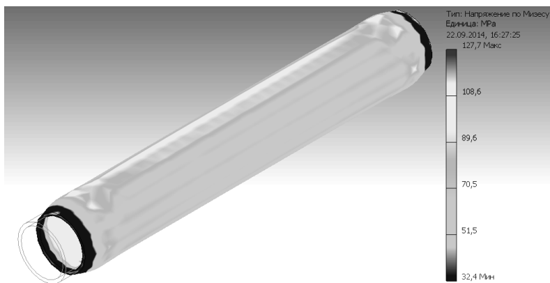
Рисунок 3. Напряженное состояние гильзы гидроцилиндра в исходной конструкции
