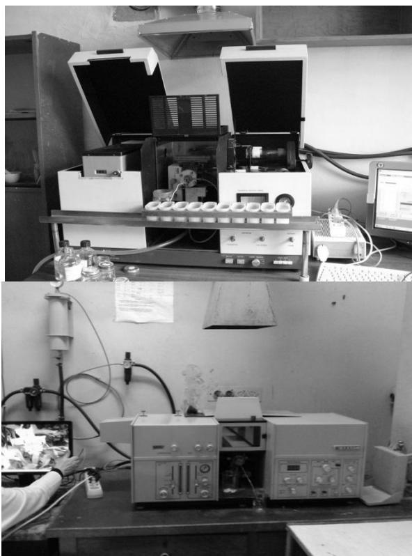
*Рисунок 2. Атомно-абсорбционные приборы*
