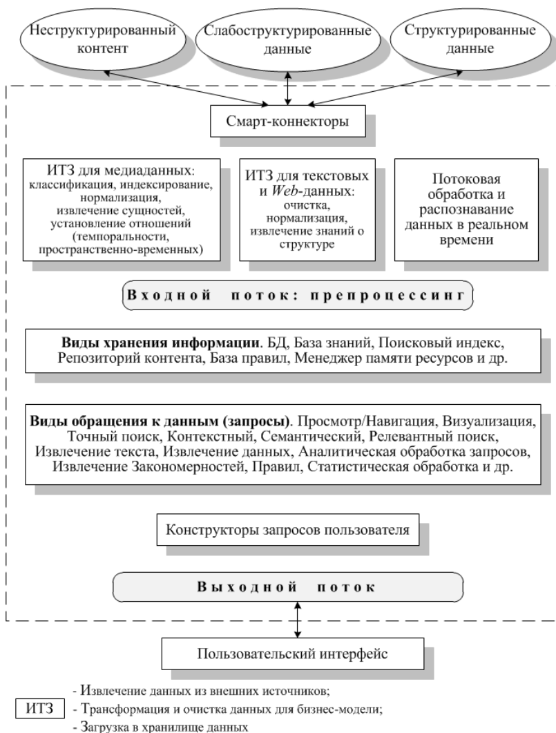
Рисунок 3. Универсальная архитектура интеллектуального анализа мультиструктурированной информации
