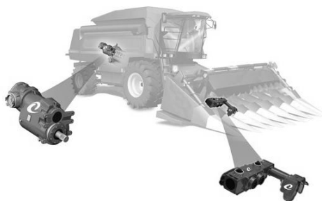
Рисунок 2. Схема расположения узлов гидравлических двигателей и приводов
