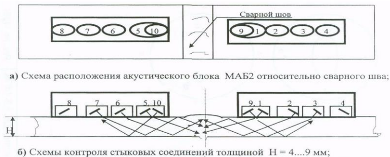
Рисунок 1. Схема контроля дефектоскопа «Скаруч»
