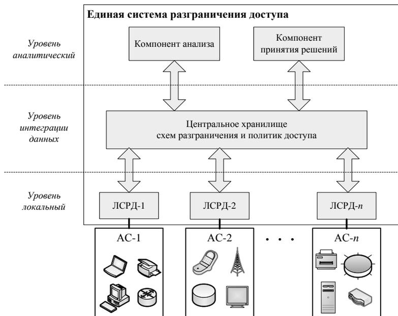
**Рисунок 1. Общая архитектура единой системы разграничения доступа**
