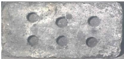
**Рисунок 1. Образец для испытания на взаимодействие с расплавами силикатов**
