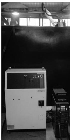
*Рисунок 2. Контроллер и источник питания*
