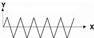
**Рисунок 5. Траектория линейного поперечного колебания**
