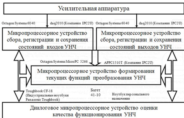
**Рисунок 3. Основные компоненты структуры устройства оценки качества функционирования низкочастотной аппаратуры**
