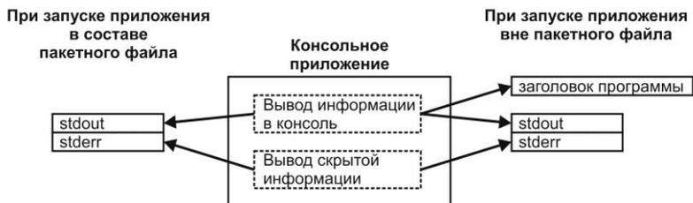
**Рисунок 2. Схема вывода информации консольного приложения в зависимости от работы ее в составе пакетного файла и работы как отдельного приложения**
