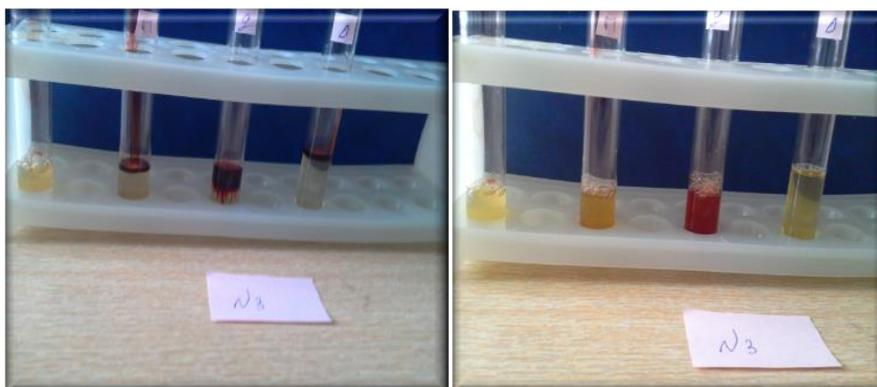
**Рис. 3. Определение ионов железа**
