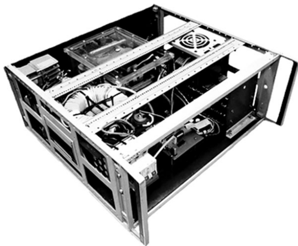
Рисунок 2. Зарядное устройство по схеме высокочастотного преобразования напряжения
