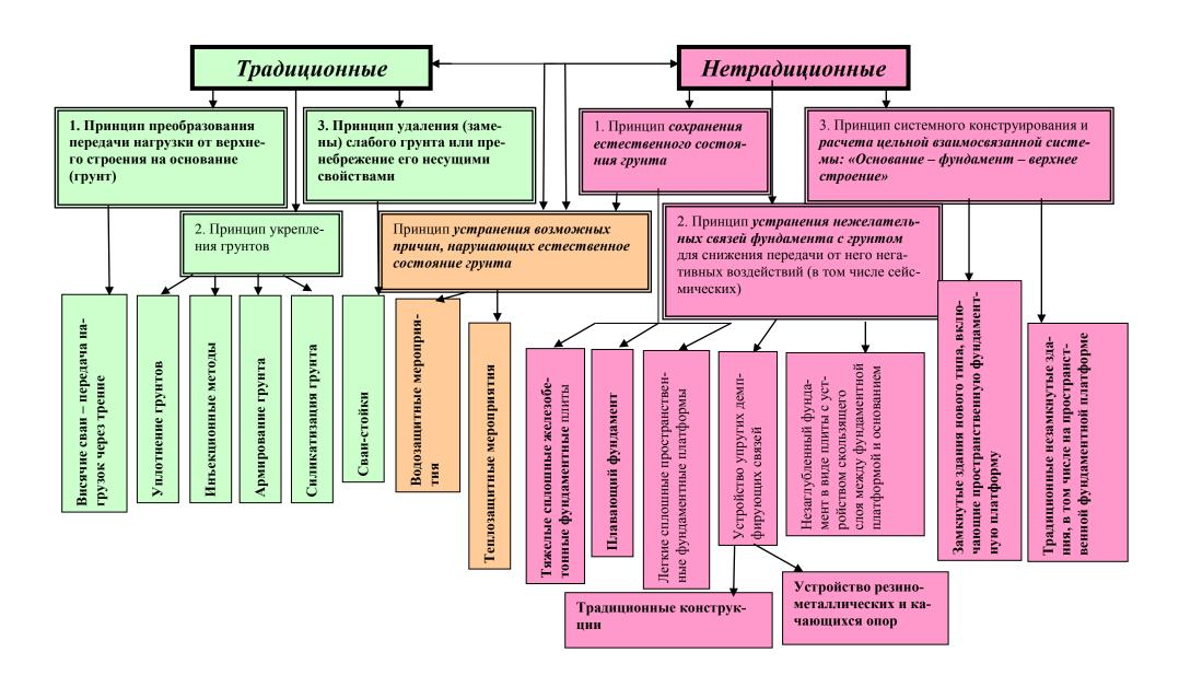
Схема 1. Принципы и способы строительства фундаментов на слабых, просадочных, пучинистых, вечномерзлых и других грунтах
