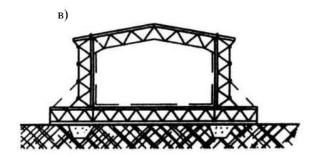
Схема 2. Комбинационный принцип: сочетание принципа сохранения естественного состояния грунта с другими принципами: а) Сочетание легких поверхностных пространственных фундаментных платформ со сваями для укрепления отдельных сильно напряженных зон; б) то же с использованием гравийной подсыпки; в) то же с частичной заменой грунта.
