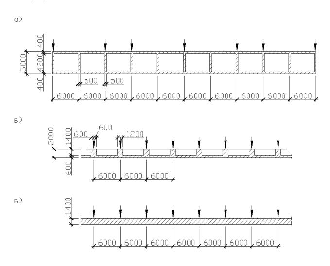
Рис. 1.1. Эволюция конструкции фундаментов многоэтажных каркасных зданий: a — полый коробчатый фундамент;  $\delta$  — ребристая фундаментная плита;  $\epsilon$  — плоская безбалочная плита
