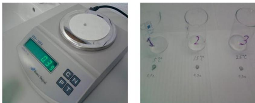
**Рисунок 5. Зависимость скорости взаимодействия цинка с разбавленной серной кислотой от температуры серной кислоты**
