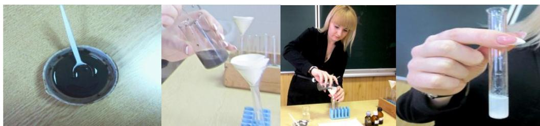
***Рисунок 5. Лабораторный эксперимент по определению хлорид ионов в грязи озера Грузского***
