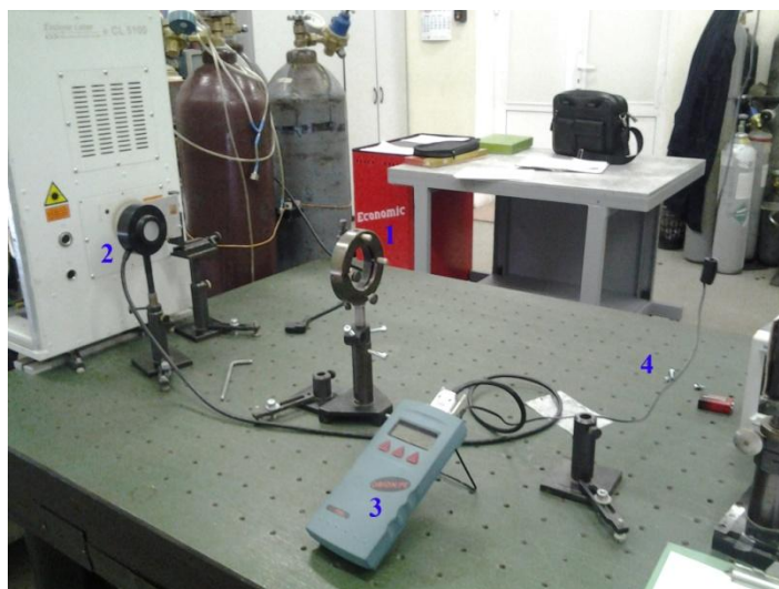
Рисунок 2. Схема измерения коэффициента отражения зеркал
