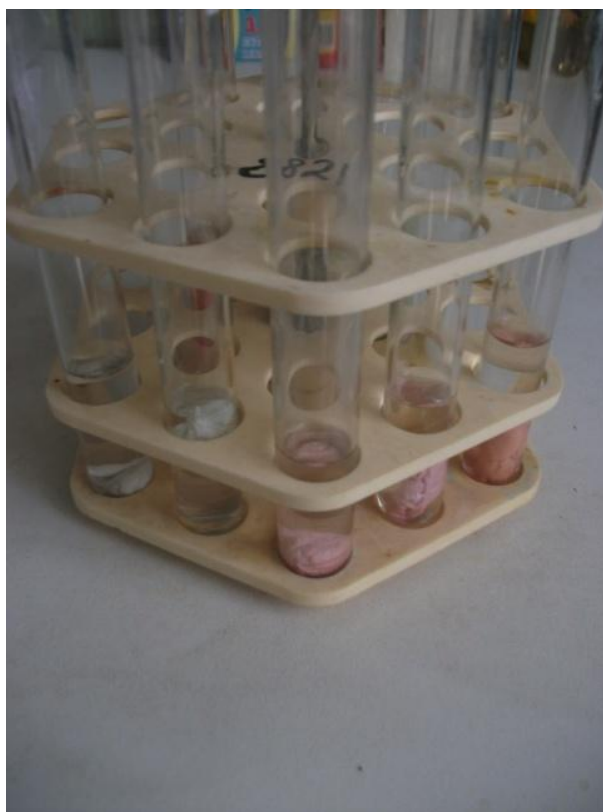
Рисунок 8. Через месяц стояния в 0,5 % соляной кислоте
